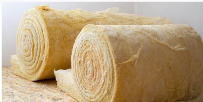
**Imagen 2. Rollos de lana de vidrio. Este material es un aislante excelente pero tiene estas desventajas: es de origen no renovable; su reciclado no está extendido y es costoso energéticamente; carece de resistencia mecánica. Fuente: CIR62**
