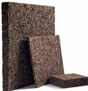
Imagen 4. Tableros de corcho negro expandido. Este material lignocelulósico es un excelente aislante, pero carece de resistencia mecánica y de cohesión, por lo que no puede usarse estructuralmente. Fuente: corcho24.es
