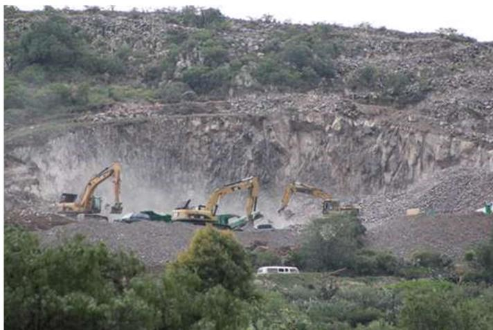
**Imagen 3. Minería a cielo abierto de rocas basálticas. Estas rocas son necesarias para la fabricación de la lana de roca, un excelente material aislante, que tiene los mismos inconvenientes que la lana de vidrio, además del fuerte impacto ambiental que supone su extracción. Fuente: Javier Salinas**
